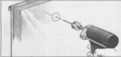
2. Spingere il perno nel materiale isolante
